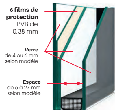
Vitrage classe P5A Protection renforcée des personnes et retardataire d'effraction.
