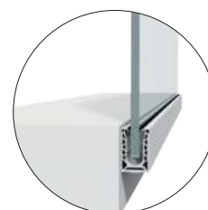
. Pose nez de dalle . Vitrage 8.8.4 trempé
