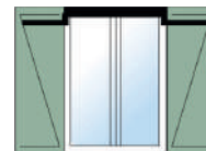
Pose sous linteau
