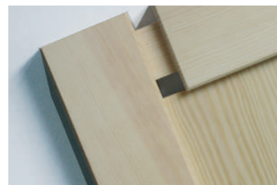
Assemblage par tenon et mortaise
