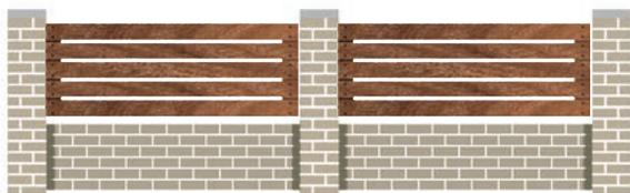
· Lames horizontales largeur entre 125 mm et 150 mm, épaisseur 15 mm avec ajourage de 25 mm
