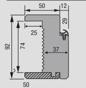
KM1 cloison 98 mm et de 105 à 400 mm
