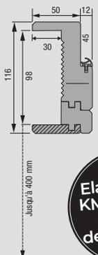
Élargisseur KM1 jusqu'à cloison de 400mm
