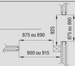
**Aligné de part et d'autre d'une cloison**
