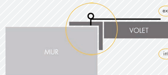
Pose en rénovation facile avec PRECADRE alu 3 côtés Le précadre recouvre les gonds coupés
