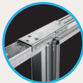
4. Raccord de renfort. Garantit l'alignement de la traverse et du coffre pour prévenir toute déformation.
