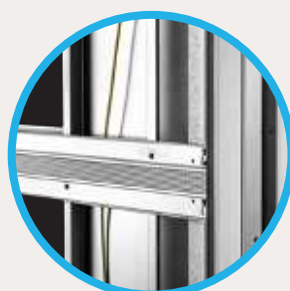
5. Goulotte de câblage. [châssis pour plaques de plâtre] Cette goulotte d'acier permet un passage facile des câbles et les isole de la porte coulissante.
