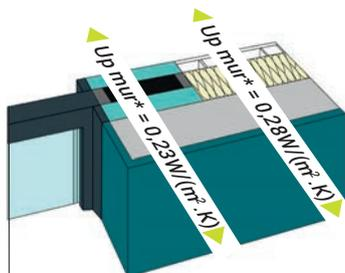
Grâce à la haute performance thermique de son isolation intégrée, le galandage isolé permet de supprimer les migrations d'air passant dans le doublage et d'obtenir sur la partie refoulement
