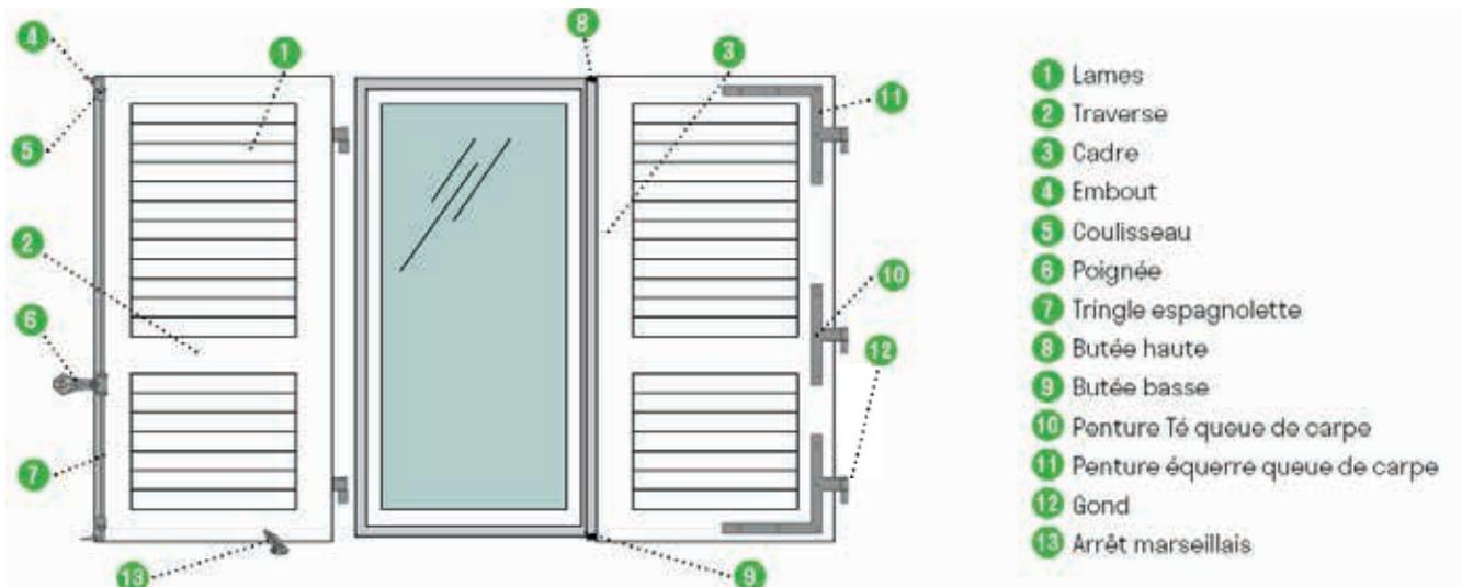
Persienne occultante de 33 mm avec encadrement composé de 2 montants et 2 traverses. Lames sans noeud et assemblées sur les montants par rainures et languettes. Traverse intermédiaire ajoutée à partir de 1690 mm de haut et 2 traverses intermédiaires à partir de 2500 mm.
