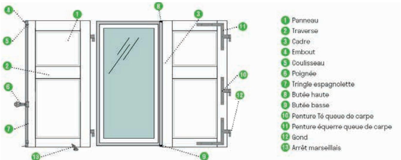
Persienne occultante de 33 mm avec encadrement composé de 2 montants et 2 traverses. Panneaux assemblés sur les montants par rainures et languettes. Traverse intermédiaire ajoutée à partir de 1690 mm de haut et 2 traverses intermédiaires à partir de 2500 mm.
