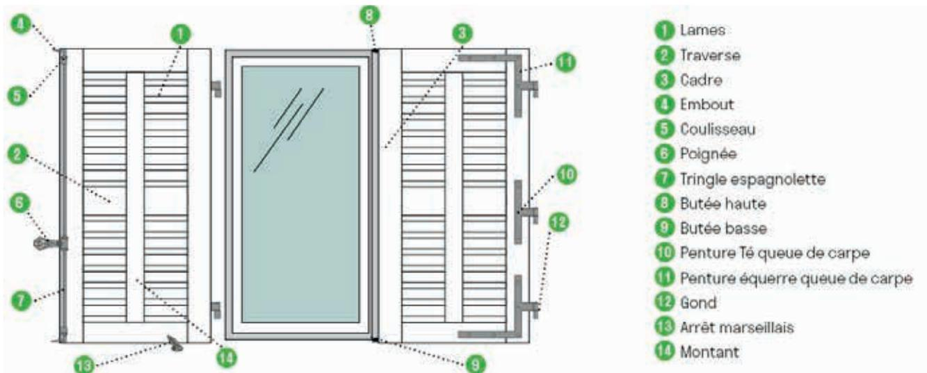
Persienne occultante de 33 mm avec encadrement composé de 2 montants et 2 traverses. Lames non ajourées droites et affleurantes, sans noeud et assemblées sur les montants par rainures et languettes. Traverse intermédiaire ajoutée à partir de 1690 mm de haut et 2 traverses intermédiaires à partir de 2500 mm.
