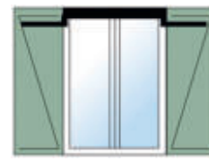
Pose sous linteau
