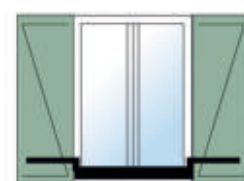
Appui de fenêtre (fixation basse)
