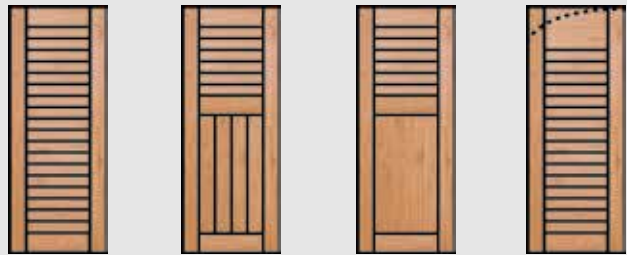
Remplissage par lamelles
