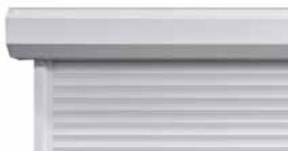
Motorisation intégrée dans le coffre de tablier. Le débord de coffre de 100 mm correspond au côté moteur positionné à gauche en standard. En option, le moteur peut être situé à droite de la porte de garage et le coffre symétrisé.
