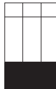
Traverse haute avec soubassement tôle.
